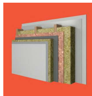
Vanjski zid Kamena fasadna vuna
