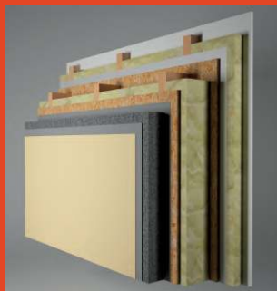
Vanjski zid EPS-sistem fasade
