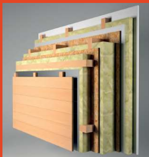
Vanjski zid Horizontalna drvena fasada
