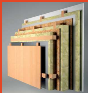
Vanjski zid Vertikalna drvena fasada
