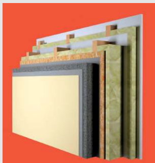
Vanjski zid EPS-sistem fasade
