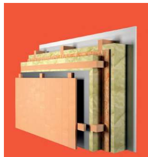
Vanjski zid Vertikalna drvena fasada
