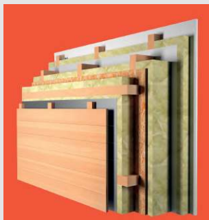
Vanjski zid Horizontalna drvena fasada
