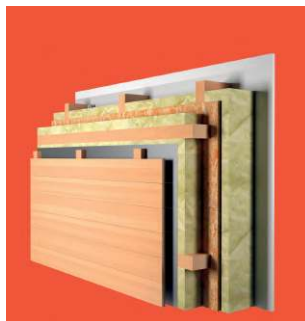
Vanjski zid Horizontalna drvena fasada
