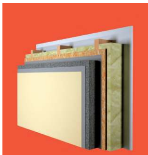
Vanjski zid EPS-sistem fasade
